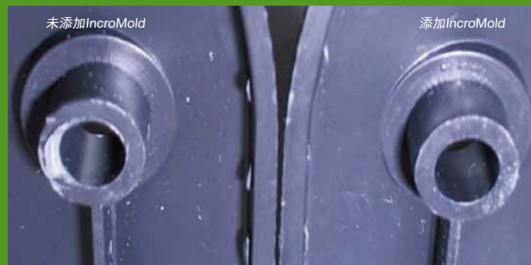
1. 添加和未添加IncroMold的注塑件质量比较
